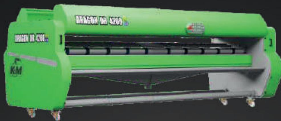
Благодаря системе сбора пыли вся пыль, грязь, шерсть, волосы и подобные посторонние предметы собираются в камеру под машиной. Более того; Благодаря легко открывающимся крышкам в камере можно легко чистить машину.
